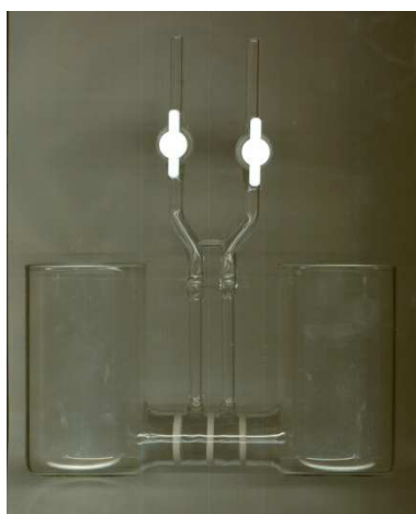
2連電解セル 3連フィルター TFコック付
