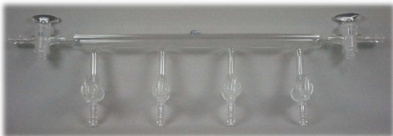
窒素ライン ニ方コックタイプ 両端コック付
